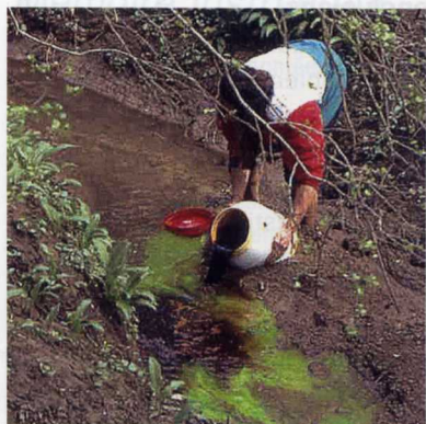
Injection de fluorescéine à la perte du Fond du Close (Meuse). Photographie Claude Herbillon.
